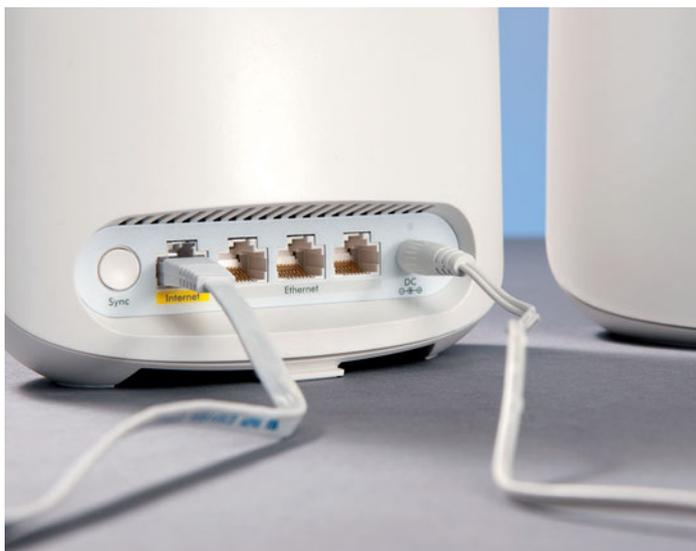
**Anschlüsse.** Dank Lan-Buchsen lassen sich PC, Fernseher oder Netzwerkspeicher auch per Kabel anschließen.
